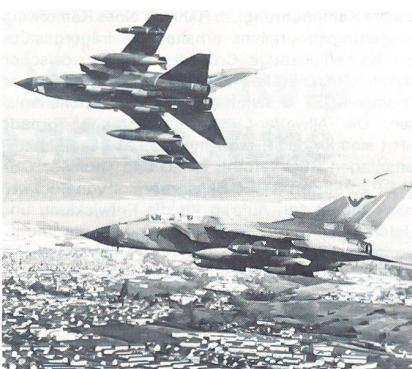
timierte Tornado 2000 erhält eine Rumpfspitze mit einem kleineren Radarquerschnitt, eine längere Zelle für die Aufnahme von zusätzlichem Treibstoff sowie eine neue Generation von Abstandswhaffen für die Zerstörung hochwertiger, gut flugabwehrgeschützter Bodenziele. Beibehalten wird der aus zwei Mantelstromturbinen RB.199 bestehende Antrieb sowie die meisten der im Rahmen des geplanten Midlife-
