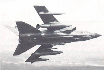
Update-Programms für den GR.1 IDS (Bild oben) zur GR.4-Konfiguration vorgesehenen Systemanpassungen. Dazu gehören ua eine digitale Rollkarte, ein Vorwärtssichtinfrarotsensor, eine neue, multifunktionale Darstellungseinheit sowie ein der zukünftigen Bedrohung angepasstes Selbstschutzesystem.
