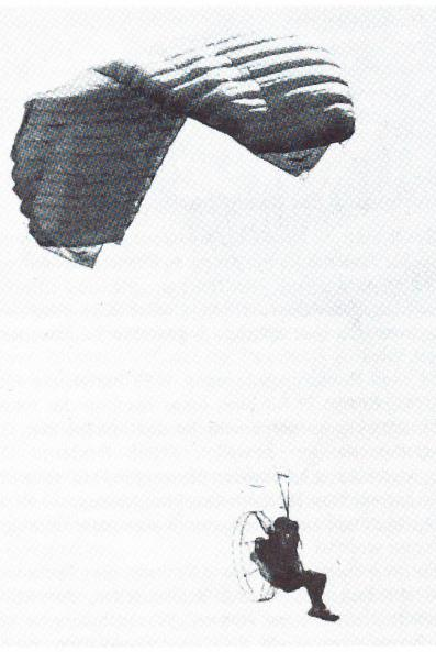
sind komplett auch in einem kleinen Kofferraum zu transportieren und könnte vor allem für Spezialeinsätze der Fallschirmjäger eingesetzt werden. Flughöhen bis zu knapp 4000 Metern und Reichweiten von 100 Kilometern sind damit zu realisieren.
