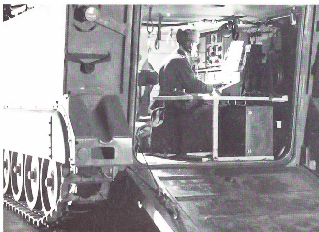
Die Kurzwellen-Funkstation SE-222 – hier panzermobil – ermöglichte der Armee ab 1956 Fernschreibverbindungen über Funk.
