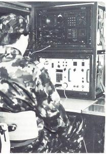
Die Kommandofunkstation SE-430 für den drahtlosen Schreibverkehr. Sie zeichnet sich durch einfache Bedienung und hohe Verbindungszuverlässigkeit
