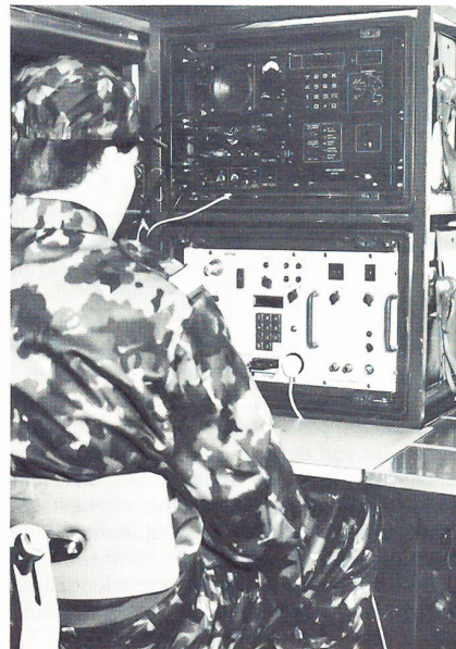
Die Kommandofunkstation SE-430 für den drahtlosen Schreibverkehr. Sie zeichnet sich durch einfache Bedienung und hohe Verbindungszuverlässigkeit aus.
