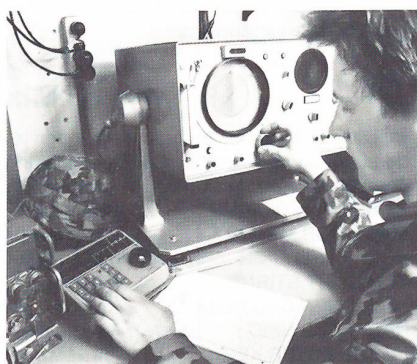
Ein EKG-Pionier an seiner viel Konzentration erheischenden Arbeit: Als «Vorposten» eines EGM-Zentrums (Elektronische Gegenmassnahmen) peilt er andere Funkstationen an, damit sie nötigenfalls gestört werden können.
