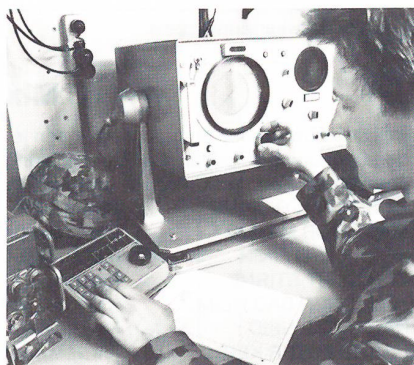
Ein EKF-Pionier an seiner viel Konzentration erheischenden Arbeit: Als «Vorposten» eines EGM-Zentrums (Elektronische Gegenmassnahmen) peilt er andere Funkstationen an, damit sie nötigenfalls gestört werden können.
