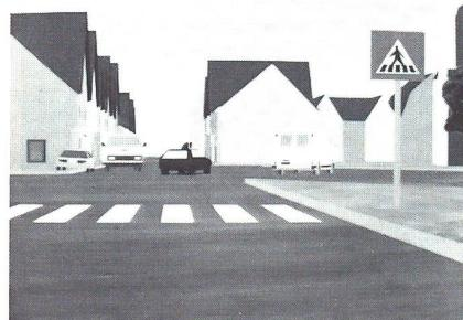
Blick vom Fahrerstand eines Panzers auf den Verkehrsablauf. In der Schweizer Armee werden Thomson-CSF-Fahrtsimulatoren für die Ausbildung der Fahrer aller verwendeten Panzer und Panzerhaubitzen eingesetzt.
