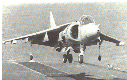
AV-8B: die Weiterentwicklung des altbekannten Senkrechtstarters HARRIER dient den MARINES in erster Linie in der Erdkampffrolle.
