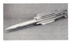
schleunigungsfähigkeit für Ausweichmanöver im Endanflug aus. Der Antrieb der ANS setzt sich aus zwei abwerfbaren Startboostern sowie einem luftatmenden Staustrahlantrieb mit integriertem Startantrieb zusammen. Flugkörper aus der Serienfertigung sollen ab Mitte der 90er Jahre der Truppe zulaufen und dort die Exocet-Lenkflugkörper ablösen. ka
