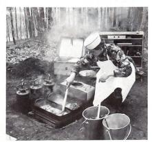
Die Benzinvergaserbrenner werden wegen der besseren Tarnung und als Schutz gegen starken Windeinfluss vergraben.
