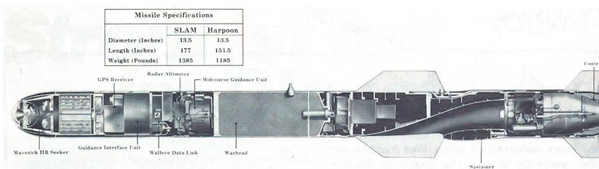
dabei eine F/A-18 Hornet. Die jüngste SLAM-Version zeichnet sich durch eine stark verbesserte Software für den Einsatz mit dem integrierten Lenkcomputer aus, was ihre Einsatzverfolge beachtlich vergrößert. Die mit einem Wärmebildzielsuchkopf und einer Zweiwegdatenübertragungsanlage ausgerüstete
