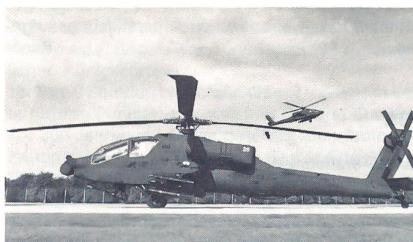
von schubstärkeren Turbinen General Electric T700-GE-701C vorbereitet (308 Einheiten). Indienststellung ab 1995.
