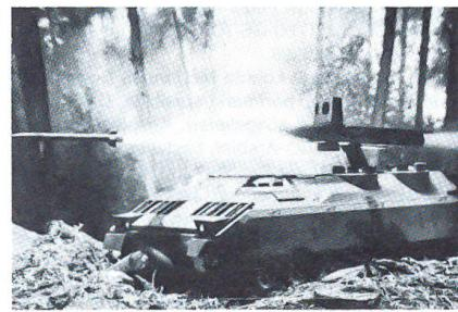
die Steuersignale über ein Feuerleitsystem mit Sensorkomponenten der Firma Texas Instruments erhält. Der Kinetic Energy Missile (KEM)-Flugkörper arbeitet mit KE-Penetratoren im Ziel. Das Modellbild zeigt den Abschuss eines LOSAT-FK aus einer abklappbaren Startlafette von einem modifizierten SPz-Fahrgestell M2 «Bradley» aus. Oberhalb der Abschlusslafette sind die Tag/Nacht-Sensoren für die Feuerleitung montiert. Aus «Soldat und Technik» Nr 8/91
