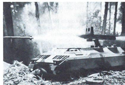
die Steuersignale über ein Feuerleitsystem mit Sensorkomponenten der Firma Texas Instruments erhält. Der Kinetic Energy Missile (KEM)-Flugkörper arbeitet mit KE-Penetratoren im Ziel. Das Modellbild zeigt den Abschuss eines LOSAT-FK aus einer abklappbaren Startlafette von einem modifizierten SPz-Fahrgestell M2 «Bradley» aus. Oberhalb der Abschlusslafette sind die Tag/Nacht-Sensoren für die Feuerleitung montiert.
