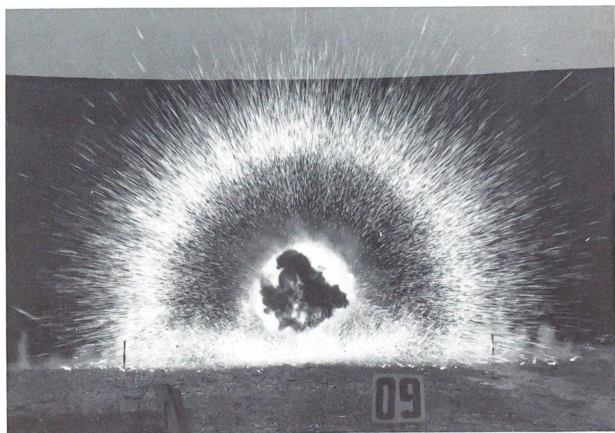
Detonierende 6-cm-Spl Br G auf dem Prüfstand
