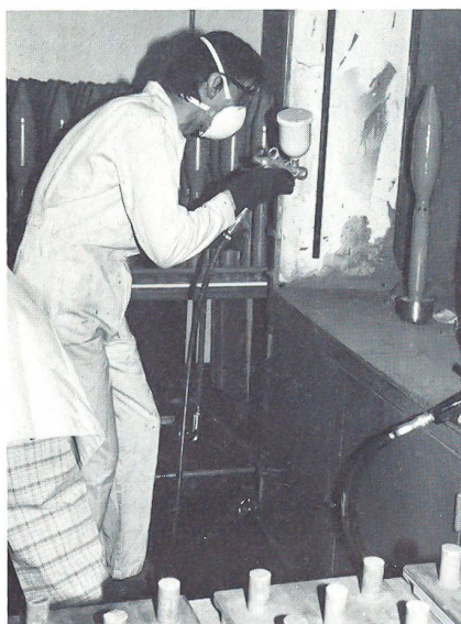
Spritzen der HPz Rak 89
