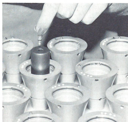
Diverse Kleinteile werden in den Arretierkörper eingesetzt, welcher das Uhrwerk und den Ausstosser enthält
