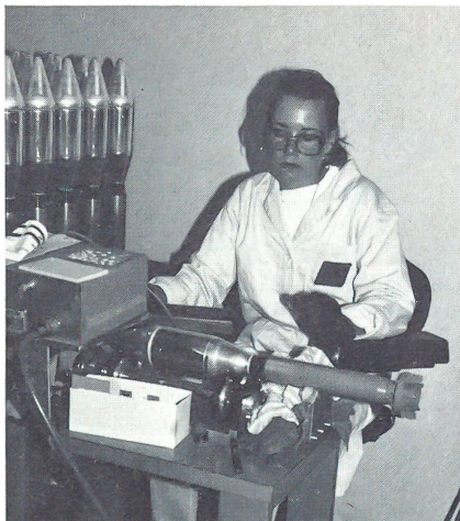
Abdichten des Gefechtskopfes der HPz Rak 89 mit Dichtungsmittel
