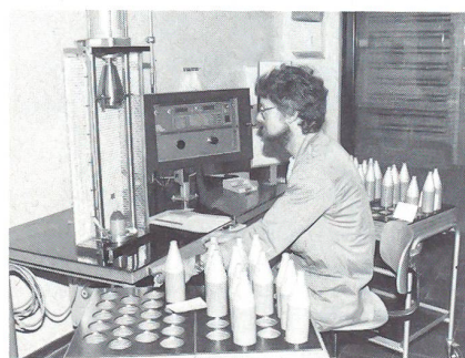
Prüfplatz für die Dichtigkeitsprobe der 6-cm-W Bel G 87 ZZ
