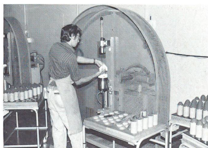
Leuchtkörper der 6-cm-W Bel G 87 ZZ werden eingesetzt, Zündkettenunterbrechung und Haube aufgesetzt
