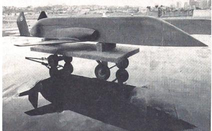
die Bildaufklärung in Quasi-Echtzeit dienen. Während die US Air Force die BQM-145A ua ab dem F-16 Fighting Falcon einsetzen will, wählte die US Navy als Träger den Jagdbomber F/A-18 Hornet. Angetrieben von einem Turbojet Teledyne CAE 382-10 erreicht das MR-UAV bei einem Bodenstart mit einer Nutzlast von rund 125 kg eine Eindringtiefe von 1200 km. ka
