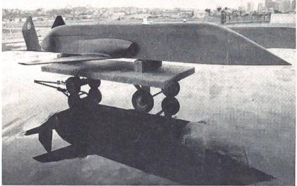
die Bildaufklärung in Quasi-Echtzeit dienen. Während die US Air Force die BQM-145A ua ab dem F-16 Fighting Falcon einsetzen will, wählte die US Navy als Träger den Jagdbomber F/A-18 Hornet. Angetrieben von einem Turbojet Teledyne CAE 382-10 erreicht das MR-UAV bei einem Bodenstart mit einer Nutzlast von rund 125 kg eine Eindringtiefe von 1200 km. ka
