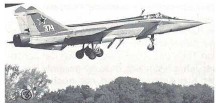
MiG-31 FOXHOUND – Die Weiterentwicklung der MiG-25 wurde am letzten Aërosalon von Le Bourget erstmals im Westen vorgestellt. Kernstück des Waffensystems ist ein Radarsystem, das dem «Abfangjäger für grosse Distanzen» einen unabhängigen Einsatz von fliegenden Radarstationen (AWACS) ermöglichen soll.
