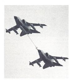
Zwei italienische Tornados zeigten eine Luft-Luft-Betankung im Tiefflug.
