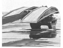
Brückenpanzer 68 des Pz Rgt 2 beim Ablegen seines Geniemittels....
