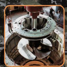
stark erosionbeschädigten Laufradmantels.
