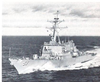
Das Bild zeigt die hochmoderne «USS Arleigh Burke» (DDG-51) bei einer Hochgeschwindigkeitsfahrt im Atlantik. Die «Burke» ist das Leitschiff einer neuen Zerstörerklasse der US Navy, verdrängt über 8000 Tonnen, ist 152 m lang und erreicht eine Geschwindigkeit um zirka 54 km/h.
