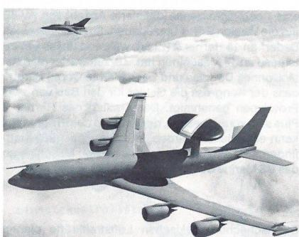
Das Bild zeigt die erste AWACS-Maschine «Sentry» für die britische Royal Air Force. Im Hintergrund eine «Tornado»-Kampfmaschine der Abfangversion F3. Abgesehen vom typischen «Radarteller» der AWACS-Maschinen unterscheidet sich die britische AWACS-Maschine von den übrigen NATO-Maschinen des gleichen Typs durch den über dem Cockpit angebrachten Luftbetankungsstutzen (Foto RAF, Strike Command).
