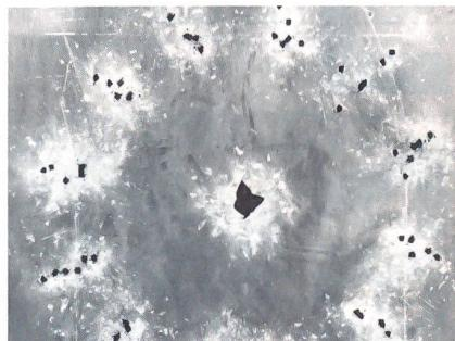
Wirkung eines AHEAD-Geschossstreffers auf eine Panzerplatte. Man beachte die konzentrisch angeordneten Ringe der Schwermetallfragmente eines einzigen Geschosses, die dank ihrer hohen kinetischen Energie die Panzerung sicher durchschlugen. ■
