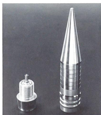
Diese Aufnahme zeigt das AHEAD-Geschoss mit dem herausgeschraubten, an der Rohrmündung programmierbaren Präzisionszeitzünder, der die Ladung zur Zerlegung des Schwermetall-Geschosskörpers unmittelbar vor dem Ziel detonieren lässt.
