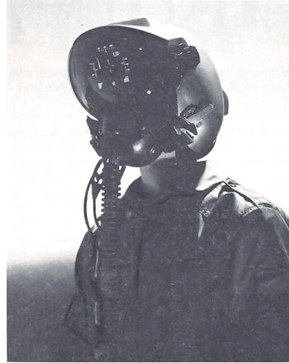
ger ua Informationen über Visierlinien, Fluglage sowie Zielpunkt. Dadurch reduziert sich für den Piloten die Notwendigkeit, den Head-Up-Display oder die Bordinstrumente zu konsultieren, was besonders im Kurvenkampf von entscheidender Bedeutung sein kann.
