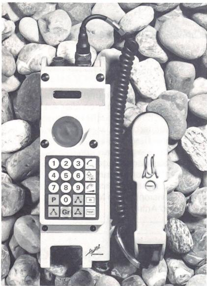
nen. Dank der induktiven Ankopplung können diese rasch und ohne Verletzung der Isolation an jeder beliebigen Stelle an das robuste Feldkabel angeschlossen werden. Diese patentierte Ankopplungsart ermöglicht es, dass dieselbe Draht immer wieder verwendet werden kann.
