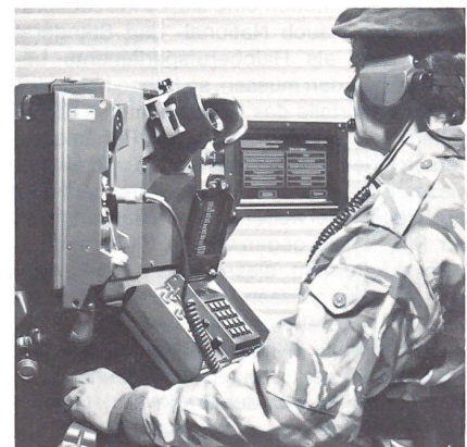
Der von Oerlikon-Contraves neuentwickelte, bereits in Serienproduktion stehende Basis-Simulator «Basim 35» ermöglicht eine optimale, mit Computer kontrollierte Ausbildung für das rechnergestützte Laserszielsystem «Gun King». Das EMD hat mit zwei Prototypen die Truppenversuche erfolgreich abgeschlossen.
