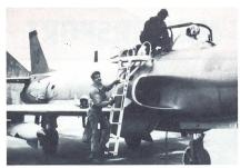
Andrea Lareida von der Sektion Avionik und Lenkwaffen vor dem Einstieg in den Lansen. Das Flugzeug J 32 B Lansen mit einer Spannweite von 13 m, Länge 14,5 m, Höhe 4,65 m, max Startgewicht (4 elektronischen Störbehältern) von ca 13 t, Maximalgeschwindigkeit Mach 1.0, max Belastung +5-3 g. Die Maschieverfügt in der *«Stör-Version»* z Zt über 8 verschiedene Störgeräte.
