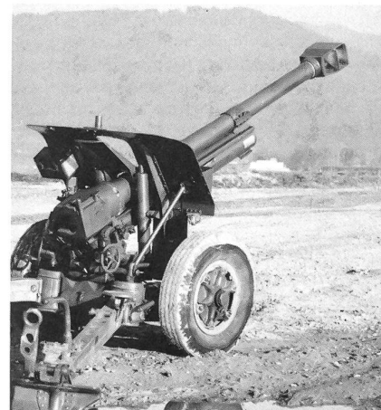
Die Steigerung der Reichweite wird mit einem neuen längeren Geschützrohr und einer zusätzlichen Ladung 6 erreicht. Dazu gehören eine neue geschmiedete – den Knalldruck und Rückstoss minimierende Mündungsbremse und die stärkeren Druckfedern.
