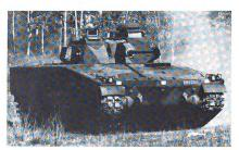
Die wichtigsten Mass- und Leistungsangaben für den mittleren Schützenpanzer CV 90: Gefechtsgewicht: 22 t; Abmessungen: (L/B/H): 6,40/3,10/2,50 m; Motor: Scania DS 14 Diesel; Motorleistung: 407 kW; Geschwindigkeit max: 70 km/h; Fahrbereich: 300 km.
