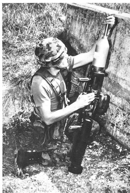
Panzerfaustschütze beim Ausziehen des Abstandsrohrs (Panzerfaust-Manipulierpatrone). Beim Schiessen mit ausgezogenem Abstandsrohr detoniert die Hohlladung im idealen Abstand und mit optimaler Wirkung im Ziel. Aus Platzgründen (Länge der Munition) werden die Panzerfaustpatronen mit eingeschobenem Abstandsrohr gelagert.
