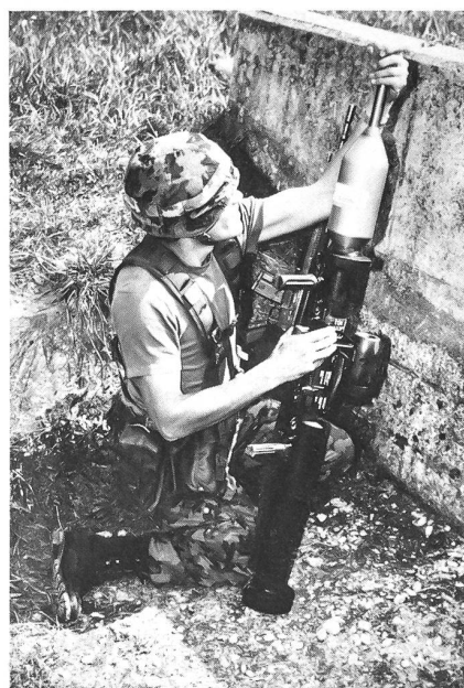
Panzerfaustschütze beim Ausziehen des Abstandsrohres (Panzerfaust-Manipulierpatrone). Beim Schiessen mit ausgezogenem Abstandsrohr detoniert die Hohlladung im idealen Abstand und mit optimaler Wirkung im Ziel. Aus Platzgründen (Länge der Munition) werden die Panzerfaustpatronen mit eingeschobenem Abstandsrohr gelagert.
