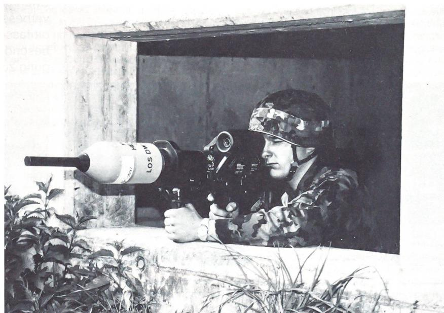
Einsatz der Panzerfaust mit Stellung in einem Kellerfenster. Im Gegensatz zum Raketenrohr erlaubt die Konstruktion der Waffe das Schiessen mit der Panzerfaust-Hohlladungspatrone aus einem geschlossenen Raum. Das System besteht aus einem wiederverwendbaren Abschussgerät und einer Hohlladungspatrone. Das Abschussgerät umfasst zwei abklappbare Griffe, eine Abfeuerungsvorrichtung sowie ein Zielfernrohr. Das Gerät wird an die Patrone angeklinkt und verriegelt.
