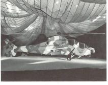
reichweite von 750 km einschliesslich einer Treibstoffreserve für 30 Flugminuten. Der 16,65 m lange Drehflügler lässt sich lageorientiert an Stummelflügeln mit Luft/Boden- und Luft/Luft-Lenkwaffen sowie ungelenkten Raketen bestücken. Unter dem Rumpfbug führt er ferner eine turmlafettierte 20-mm-Maschinenkanone mit. Für die Zielauffassung und den Waffeneinsatz stehen der zweiköpfigen Besatzung in Tandemanordnung ein stabilisiertes, auf
