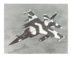
eine unter dem Rumpf) verschiedenen Aufhängepunkten befestigt werden können. So können bis zu 14 Bomben diverser Konfigurationen und 144 Raketen mitgeführt werden. Die Mirage F1 kann diverse Lenkwaffentypen aufnehmen, unter anderem die Anti-Radar-Lenkwaffe Armat, die im Falklandkrieg bewährte Luft-/Boden-Lenkwaffe Exocet sowie lasergesteuerte Waffensysteme und Systeme für elektronische Gegen- und Schutzmassnahmen.
