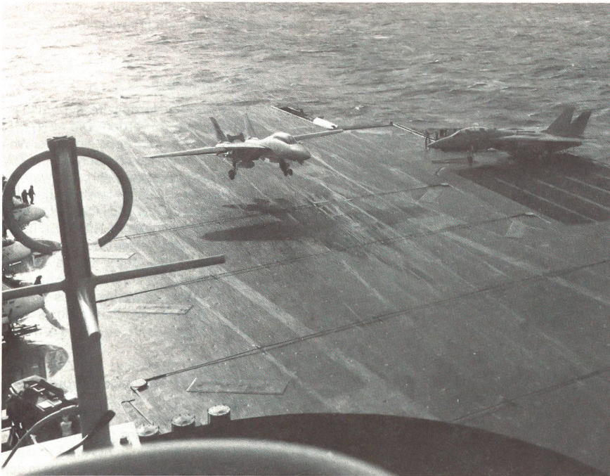
Ein F-14A-Abfangjäger «Tomcat» landet nach erfolgter Mission auf dem glitschigen Deck des Flugzeugträgers «Enterprise». Die Landegeschwindigkeit der rund 20 Tonnen schweren Maschinen beträgt um die 230 km/h, die Fangseile bremsen die Maschine auf einer Strecke von zirka 160 Metern auf Null ab.
