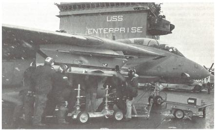
Im leichten Schneetreiben wird ein F-14A-*«Tomcat»-*Abfangjäger der Staffel 114 *«Fighting Aardvarks»* mit einer Luft-Luft-Lenkwaffe des Typs *«Sparrow»* bewaffnet. Im Hintergrund ist der Turm des atomgetriebenen Flugzeugträgers *«Enterprise»* erkennbar.
