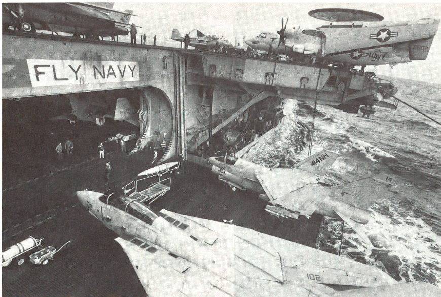
Auf vier schweren Lifts werden die Kampfflugzeuge der «Enterprise» vom Hangardeck (unten) auf das Flugdeck gehoben. Unten sieht man eine F-14A «Tomcat» und eine A-7E «Corsair», oben auf dem Flugdeck eine parkierte E-2C-«Hawkeye»-Radarfrühwarn- und -aufklärungsmaschine der Staffel VAW-117 «Night Hawks». Von dieser sind vier Maschinen auf dem Träger stationiert.
