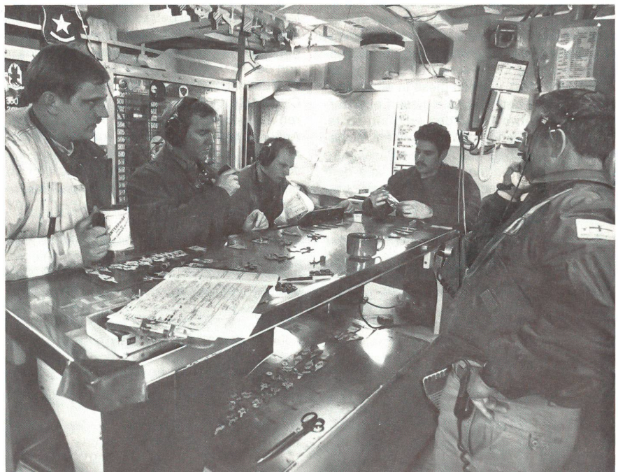
Um eine Kontrolle über die Standorte jeder einzelnen Maschine auf der «Enterprise» zu haben, wird jede einzelne Bewegung mittels Telefon in diese Kontrollzentrale (Flight Deck Control) gemeldet, wo sie mittels Modellen nachvollzogen wird. Die engen Verhältnisse und die gegen 90 Flugzeuge auf dem Träger zwingen zu diesem rationalen Betrieb.
