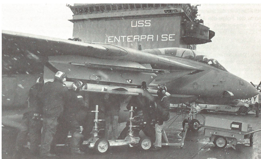
Im leichten Schneetreiben wird ein F-14A-«Tomcat»-Abfangjäger der Staffel 114 «Fighting Aardvarks» mit einer Luft-Luft-Lenkwanne des Typs «Sparrow» bewaffnet. Im Hintergrund ist der Turm des atomgetriebenen Flugzeugträgers «Enterprise» erkennbar.
