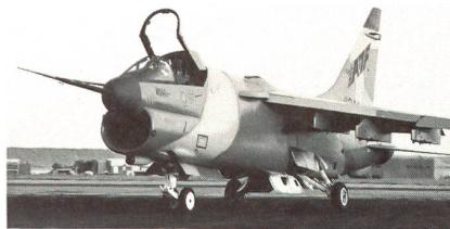
A-7F an sechs Unterflügel- und zwei Unterrumpfstationen bis zu 7,8 Tonnen Nutzlast, darunter praktisch alle im Inventar der US Air Force vorhandenen Luft/Boden-Waffen, mitführen können. LTV schlägt das Kampfverteidigungsprogramm A-7F für die Modernisierung der gesamten Flotte von mehr als 300 A-7D und A-7K Corsair II Apparate der US Air National Guard vor. ka
