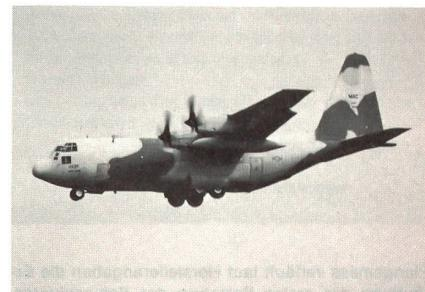
sieren –, wird mit leistungsfähigeren Allison T56 Series IV-Motoren ausgerüstet werden. Die neuste «Hercules»-Version soll bei der US-Luftwaffe die 194 Maschinen vom Typ C-130E, die seit Mitte der 60er Jahre im Einsatz stehen, ablösen.
