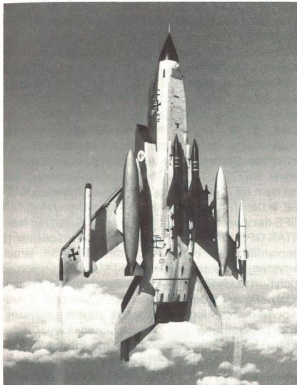
handelt es sich um einen Anti-Radar-Lenkflugkörper, während die «Kormoran» als Luft/Schiff-Lenkwaaffe eingesetzt wird. Diese Misch-Konfiguration unterschiedlicher Lenkwaffen ist besonders für die Tornados der Bundesmarine und der italienischen Luftwaffe von grosser Bedeutung. Bei dem Testflug wurde in erster Linie das Zusammenwirken der einzelnen Lenkwaffen mit der Tornado-Avionik und den relevanten Modulen der operationellen Flug-Software-Systeme überprüft.
