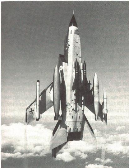
handelt es sich um einen Anti-Radar-Lenkflugkörper, während die «Kormoran» als Luft/Schiff-Lenkwaaffe eingesetzt wird. Diese Misch-Konfiguration unterschiedlicher Lenkwaffen ist besonders für die Tornados der Bundesmarine und der italienischen Luftwaffe von grosser Bedeutung. Bei dem Testflug wurde in erster Linie das Zusammenwirken der einzelnen Lenkwaffen mit der Tornado-Avionik und den relevanten Modulen der operationellen Flug-Software-Systeme überprüft. ki
