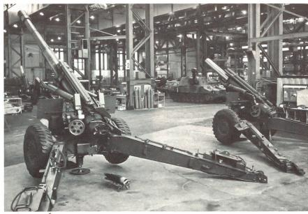
Rechts die alte ÚS-M-114-Haubitze. Links die kampfwertgesteigerte Haubitze 155 mm M 114/39. Die maximale Schussweite beträgt 32 km (mit Base Bleed) und die Erstschlagfähigkeit ist 3 Schuss 14 Sekunden. Die Kampfwertsteigerung wurde von der holländischen Firma RDM Rotterdam zusammen mit Bofors Schweden verwirklicht
