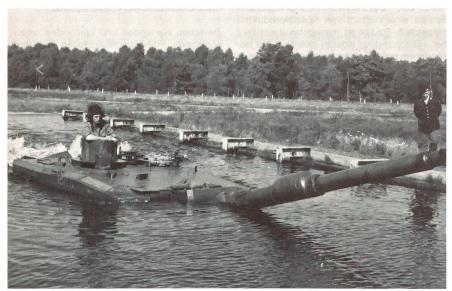
Tiefwasservorführung mit dem Panzer Leo 2. Die Watfähigkeit beträgt normalerweise 1,2 m. Mit der gezeigten Zusatzausrüstung 2,35 m. Die Vorbereitungszeit beträgt 20 Minuten. Die niederländische Armee verfügt über 450 Pz Leo 2 und über 450 PS Leo 1.
