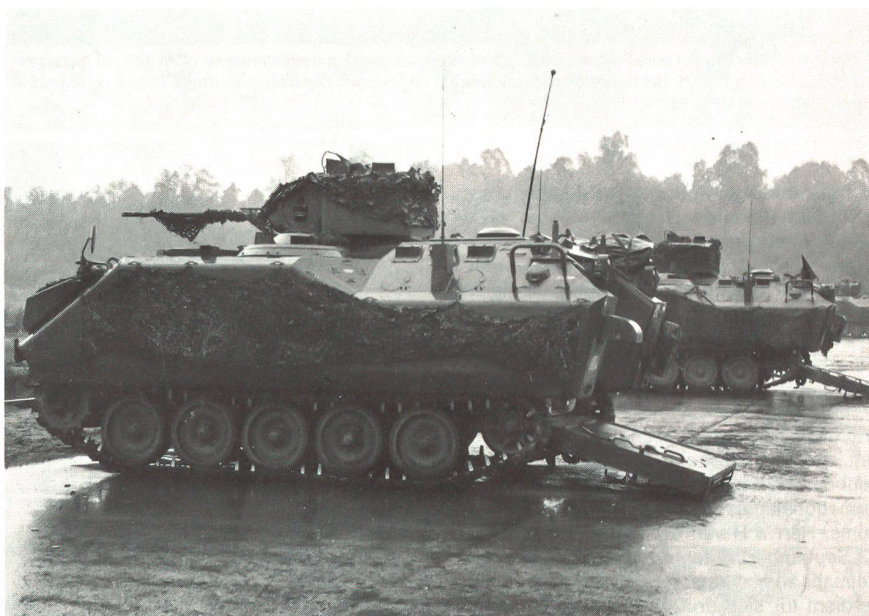
Der Schützenpanzer PR 765 vor dem Gefechtsschiessen. Dieser Spz wurde aufgrund einer weiterentwickelten Version M 113 zum holländischen Kampffahrzeug umgebaut. Die Waffe ist eine 25-mm-Maschinenkanone Oerlikon.
