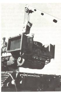
Motorenwechsel beim Panzer Leo 1.
