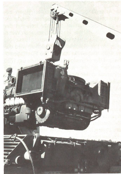
Motorenwechsel beim Panzer Leo 1.
