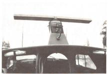
Jedes P80 ist mit einem Radar ausgerüstet
