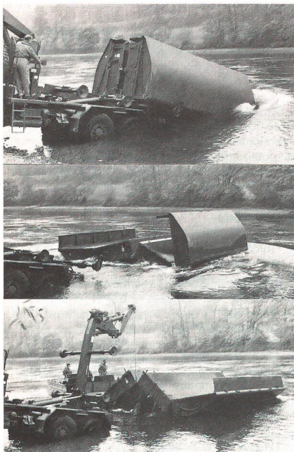
Ein Element der deutschen Falt-Schwimmbrücke FSB 2000 wird «entblättert», das heisst aufs Wasser gesetzt.
