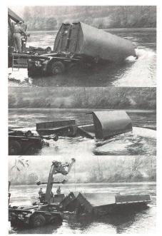
Ein Element der deutschen Falt-Schwimmbrücke FSB 2000 wird «entblättert», das heisst aufs Wasser gesetzt.
