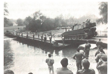
Eine Kompanie des Premier Régiment du Genie de l'Armée française demonstrierte bei Brugg den neuen «Pont flottant motorisé».
