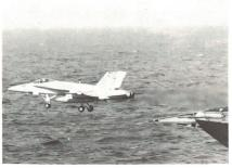
Auf den Flugzeugträgern der US Navy befinden sich u a je zwei Staffeln des Typs F/A-18 «Hornet», die sowohl als Kampfbomber wie auch als Abfangjäger eingesetzt werden können. Die Aufnahme zeigt den Katapultstart einer «Hornet» der Staffel VFA-83 vom Marinefliegergeschwader 17 vom Deck des Flugzeugträgers «Saratoga».
