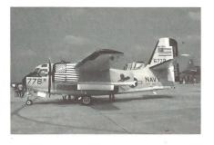
Tag und Nacht für Such- und Rettungseinsätze im Dienst. Unzählige Schiffbrüchige verdanken dem Tracker ihr Leben. Die Besatzung bestand in der Regel aus drei Mann: Pilot, Copilot sowie einem Systemoperateur. Ausgerüstet waren die Tracker mit einem Radar, einem Omega-Navigationssystem sowie Kameras für Tag- und Nacht- respektive Schlechtwettereinsätze (Bild: Tracker der US Navy).
