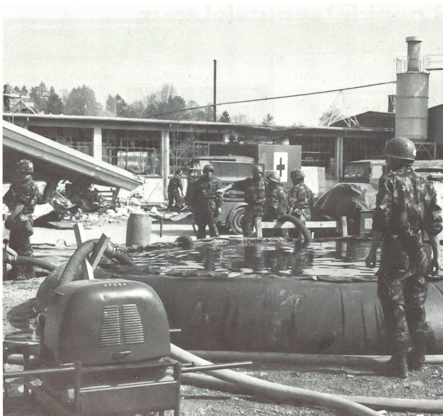
Mit Luft aufpumpbares Reservoir für das Löschwasser.
