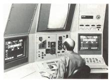
Der Fluglehrer überwacht den Pilotenschüler von der Instruktorenstation aus, die sich ausserhalb des Simulator-Kugeldoms befindet. (Fotodienst Emmen)
