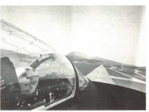
Das Cockpit des Hawk-Simulators entspricht bis ins letzte Detail dem Original. Der Pilotenschüler arbeitet darin voll ausgerüstet mit Fliegerkombi, Anti-g-Anzug, Sauerstoffmaske und Helm.
