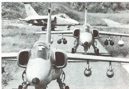
AMX - ein leichtes Erdkampfflugzeug, das von Brasilien und Italien gemeinsam gebaut wird. Der einstrahlige Hochdecker mit kleinen runden Luftenläsen führt an den Flügelspitzen Lenkwaffen mit.
