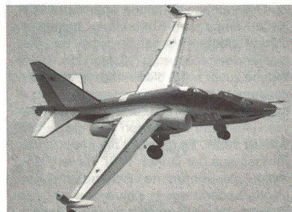
SU-25 FROGFOOT – beachte den langen, ungepfeilten Flügel mit den aerodynamischen Bremsen an den Flügelen.
