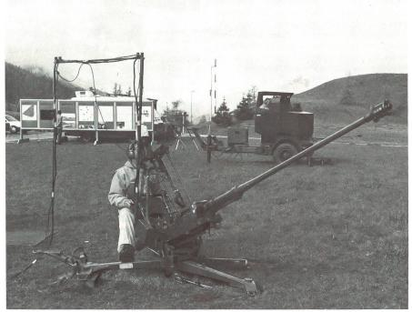
GUN-STAR-Feuerleitgerät (im Hintergrund) mit 20-mm-Geschütz. Bis zu sechs Geschütze können vom Feuerleitgerät angesteuert werden.
