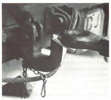
Die «pfiffige» Lösung des Anhängerproblems. Das Militärsackmesser als gefahrlose Schiebefläche über dem Anhängehaken beim rückwärts Manövrieren.
