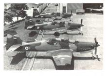
Whitney-PT6A-25C-Motor ausgerüstet und hat ein maximales Startgewicht von 3175 kg. Die Maschine deckt ein weites Spektrum der fliegerischen Ausbildung ab, so können sowohl elementare Grundschulung wie auch taktische Einsätze mit Waffensystemen geschult werden. An vier Aussenstationen unter den Flügeln können rund 1000 kg Waffenzuladungen (Maschinengewehrbehälter, Raketenwerfer und Bomben) befestigt werden.
