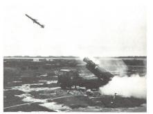
Werferfahrzeug für die Boden-See-Lenkwaffe des Types SSM-1
