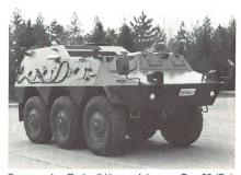
Gepanzertes Radaufklärungsfahrzeug Typ 82 (Entwurf Mitsubishi), gebaut von Komatsu. 13,6 t schwer.
