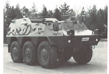
Gepanzertes Radaufklärungsfahrzeug Typ 82 (Entwurf Mitsubishi), gebaut von Komatsu, 13,6 t schwer.
