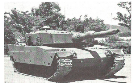
Der neue japanische Kampfpanzer TK-X Typ 90. 3 Mann Besatzung. Gewicht 50 t, Bewaffnung 120-mm-Glattrohrkanone, 2 MG. Generalunternehmer Mitsubishi.
