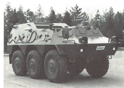
Gepanzertes Radaufklärungsfahrzeug Typ 82 (Entwurf Mitsubishi), gebaut von Komatsu, 13,6 t schwer.
