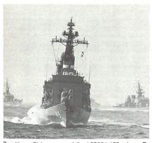
Zerstörer «Shirane», verdrängt 5200 t, 159 m lang. Zu dieser Klasse gehören zwei Einheiten, die 1978 und 1979 gebaut wurden. Bewaffnet mit zwei 12,7-cm-Geschützen, zwei Phalanx-Nahbereichsflugkörper-Abwehrsystemen, einem Sea Sparrow Schiff-Luft Lenkwaffenwerfer sowie mit drei U-Boot-Abwehr-Helikoptern.
