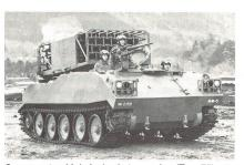
Gepanzerter Mehrfachraketenwerfer (Typ 75), der über 30 Startvorrichtungen für 130-mm-Raketen verfügt. Variante des Schützenpanzers (Typ 73) und hergestellt von Mitsubishi.
