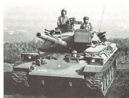
Kampfpanzer des Typs 74 (gebaut von Mitsubishi), mit Infrarot/Weisslichtgerät. 4 Mann Besatzung, 38 t schwer, ausgerüstet mit 105-mm-Kanone.
