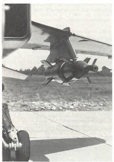
westlichen Nachbarlandes setzt die 400-kg-Laserlenkbombe BGL mit der Waffensystemkombination Jaguar/ATLIS der FATAC ein. Anlässlich der vorerwähnten Einsatzevaluation bekämpften Erdkampfflugzeuge Jaguar der Armee de l'Air aus einem Angriffsprofil im Tiefflug mit der BGL hochwertige, gut flugabwehrgeschützte Punktziele aus einer Abstandsposition bis zu 7 km. Dabei sollen mit dieser Laserlenkbombe Ablagen von weniger als einem Meter erzielt worden sein. (ADLG 6/88: BGL/Arcole)
