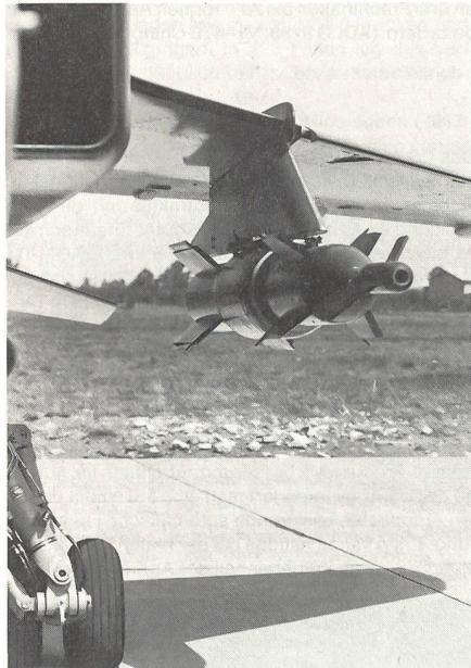
westlichen Nachbarlandes setzt die 400-kg-Laserlenkbombe BGL mit der Waffensystemkombination Jaguar/ATLIS der FATAc ein. Anlässlich der vorerwähnten Einsatzevaluation bekämpften Erdkampfflugzeuge Jaguar der Armee de l'Air aus einem Angriffsprofil im Tiefflug mit der BGL hochwertige, gut flugabwehrschützende Punkzziele aus einer Abstandposition bis zu 7 km. Dabei sollen mit dieser Laserlenkbombe Ablagen von weniger als einem Meter erzielt worden sein. (ADLG 6/88: BGL/Arcole) ka
