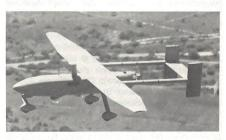
abflugbereit 180 Kilogramm. Von diesem Gewicht entfallen 40 Kilogramm auf die aus einer stabilisierten Videokamera und einer Datenübertragungsanlage bestehenden Nutzlast. Die von einem Druckpropeller angetriebene Seeker offeriert eine maximale Flugdauer von 9 Stunden. Dies erlaubt der Aufklärungsdrohne bei einem Aktionsradius von 200 Kilometern, während rund 2,5 Stunden im Zielgebiet zu verweilen.
