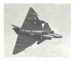
wurden auch die Tragflugversuche mit dem für den Einsatz mit dem Gripen in der Luftangriffsrolle bei MBB in Auftrag gegebenen Abstandslenkflugkörper DWS 39 aufgenommen. Unser Foto zeigt diesen auf der MW-1 Technologie basierenden Streuwaffendispenser für die Erdzielbekämpfung ohne Zielüberflug an der rechten Unterflügellaststation eines als Versuchsträger dienenden Luftangriffsflugzeugs AJ37 Viggen. (ADLG 7/87: JAS 39 Gripen und ADLG 11/87: DWS 39)
