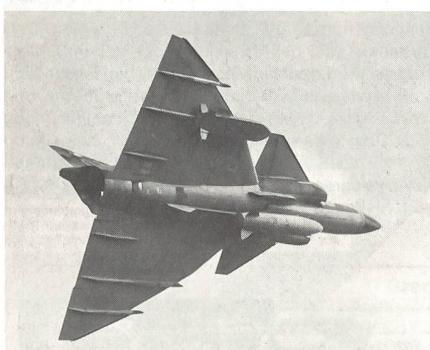
wurden auch die Tragflugversuche mit dem für den Einsatz mit dem Gripen in der Luftangriffsrolle bei MBB in Auftrag gegebenen Abstandslenkflugkörper DWS 39 aufgenommen. Unser Foto zeigt diesen auf der MW-1 Technologie basierenden Streuwaffendispenser für die Erdzielbekämpfung ohne Zielüberflug an der rechten Unterflügelleaststation eines als Versuchsträger dienenden Luftangriffsflugzeugs AJ37 Viggen. (ADLG 7/87: JAS 39 Gripen und ADLG 11/87: DWS 39)
