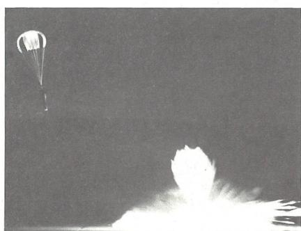
Tandemkonfiguration mit geführte Sprengladung unter die Piste, wo sie verdämmt zur Explosion gelangt. (ADLG 1/89: Hades)
