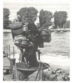
Zwei Geschütze befinden sich auf der Pionierfähre BODAN. Die BMK 20 mm (Bordmaschinenkanone). Es sind zwei Kasten mit 75 Schuss Munition einsetzbar.
