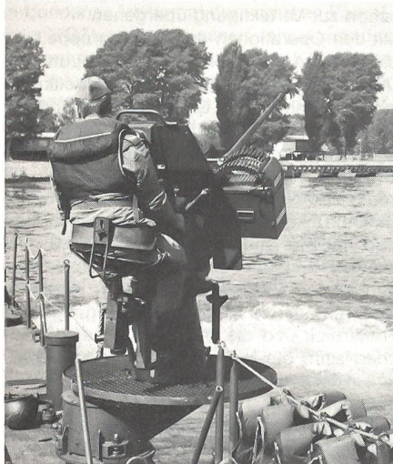
Zwei Geschütze befinden sich auf der Pionierfähre BODAN. Die BMK 20 mm (Bordmaschinenkanone). Es sind zwei Kisten mit 75 Schuss Munition einsetzbar.
