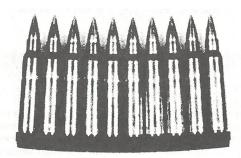
lich tieferem Geschossgewicht wird mit dem Kaliber 5,6 mm eine grössere Wirkung im Ziel erreicht. Die Gründe dafür liegen bei einer höheren Anfangs- und Endgeschwindigkeit sowie einer optimierten Geschosskonstruktion.
